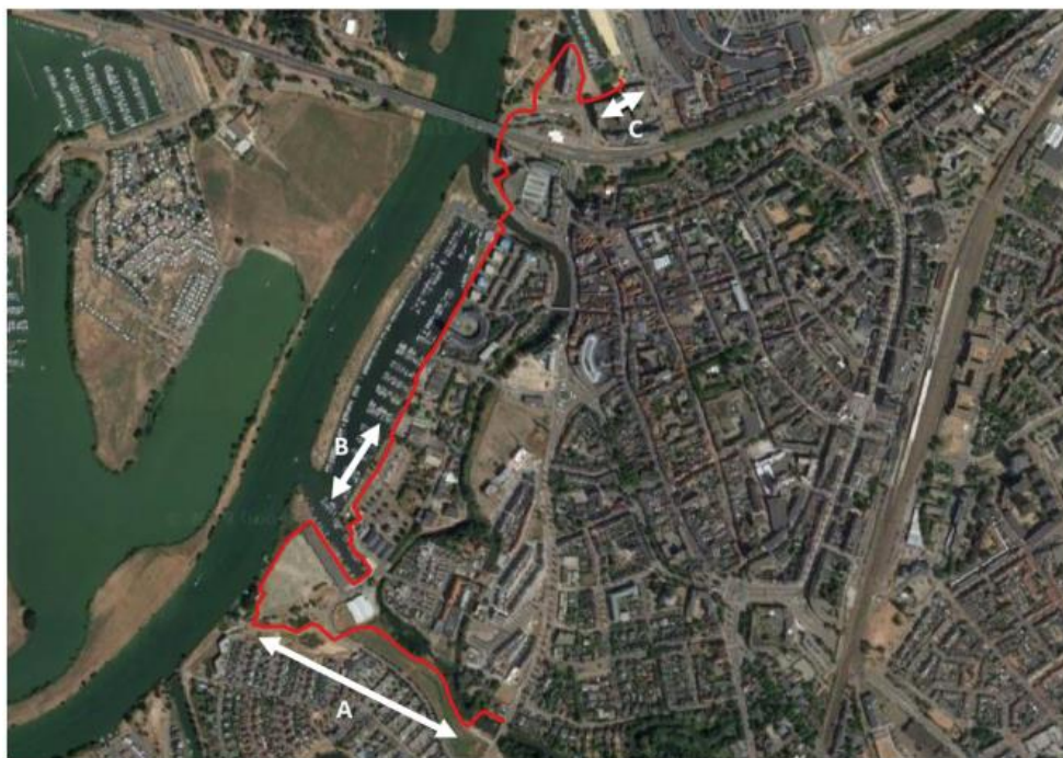
Figuur 1.1 Dijktraject 76-1 met de belangrijkste zwakke plekken
