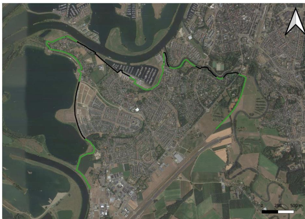
Figuur 3.1 Dijktraject 77-1 Roermond Merum-Ool-Herten. Groene keringen zijn aangegeven met groen, en langsconstructies met zwart.
